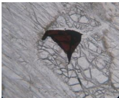
Նկ. 3: Քրոմիտային սերպենտինիտ (քրոմիտային հանքաքար): Քրոմիտի ուղանկյունաձև հատիկները հատվում են վերանստեցված, վերաբյուրեղացված թե, անման երակիկներով: Շլիֆ 355, առանց անալիզատորի, d=5 մմ:
